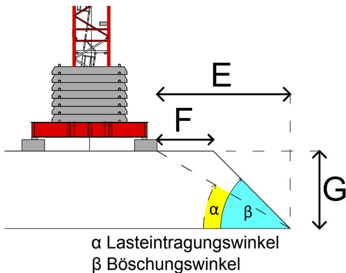
$\alpha \leq 30^\circ$  bei aufgeschütteten oder rolligen Böden (  $E > 2 \times G$  )
